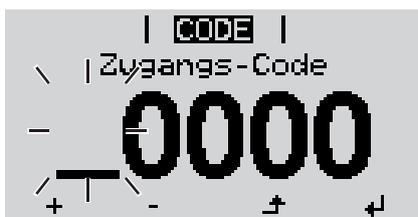
Im Menü 'CODE' wird 'Zugangs-Code' angezeigt, die erste Stelle blinkt. Der Zugangs-Code für das CONFIG Menü lautet: 39872
