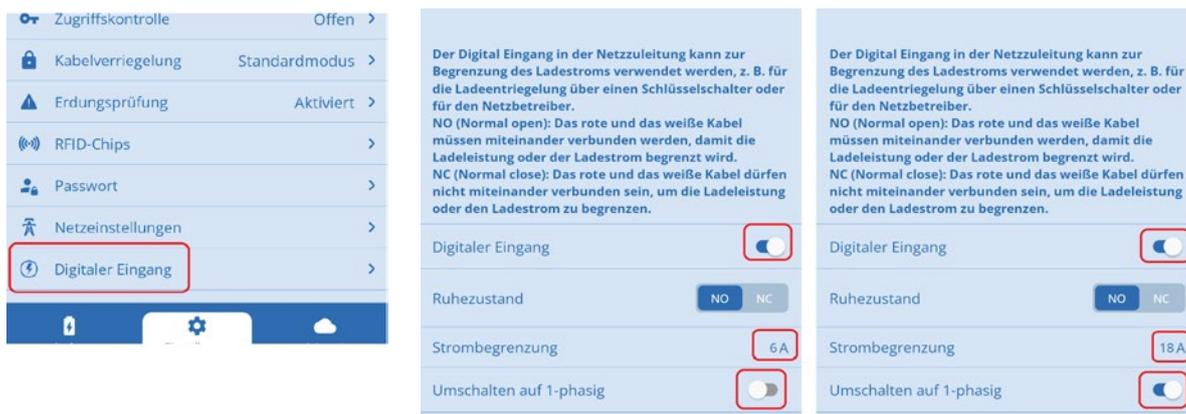
Der Digital Eingang in der Netzzuleitung kann zur Begrenzung des Ladestroms verwendet werden, z. B. für die Ladeentriegelung über einen Schüsselschalter oder für den Netzbetreiber.
