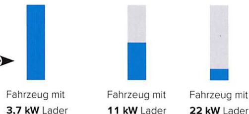
Ein Kleinwagen mit einer 22 kWh Batterie kann zum Beispiel mit einer 22 kW AMTRON® Heimpladestation in rund einer Stunde wieder aufgeladen werden, wenn der Lader an Bord des Fahrzeugs das Laden mit 22 kW unterstützt. Das gleiche Fahrzeug kann auch mit einer 3,7 kW Heimpladestation aufgeladen werden.
