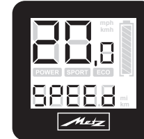
Anzeige der maximalen Geschwindigkeit im gewählten Fahrmodus (Standard-Modus 20 km/h – oder Schrittempo-Modus 6 km/h)
