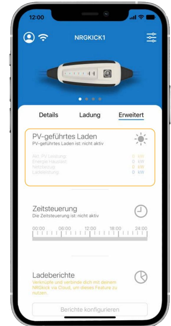
**10.4.** Nun siehst du in der App die neu freigeschaltene Funktion „PV-geführtes Laden“. Indem du nun auf „PV-geführtes-Laden“ tippst, kannst du die Einrichtung starten.
