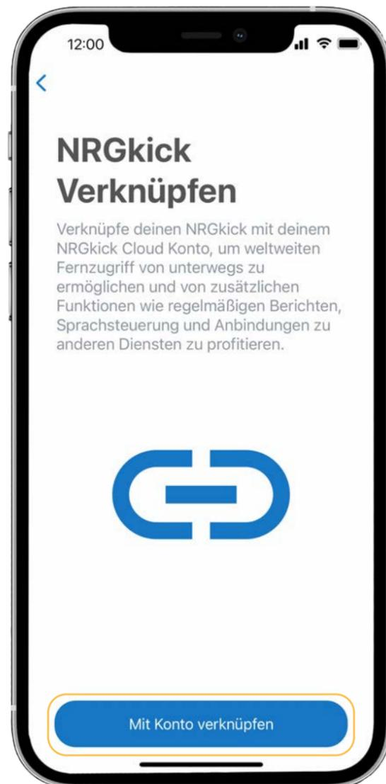
**4.5.** Sollte bei der Ersteinrichtung kein Cloud Account eingerichtet werden, können Sie dies jederzeit nachholen. Öffnen Sie dazu die App und begeben Sie sich in die Nähe des NRGkick (< 10m), da die Verbindung zunächst über Bluetooth aufgebaut wird.
